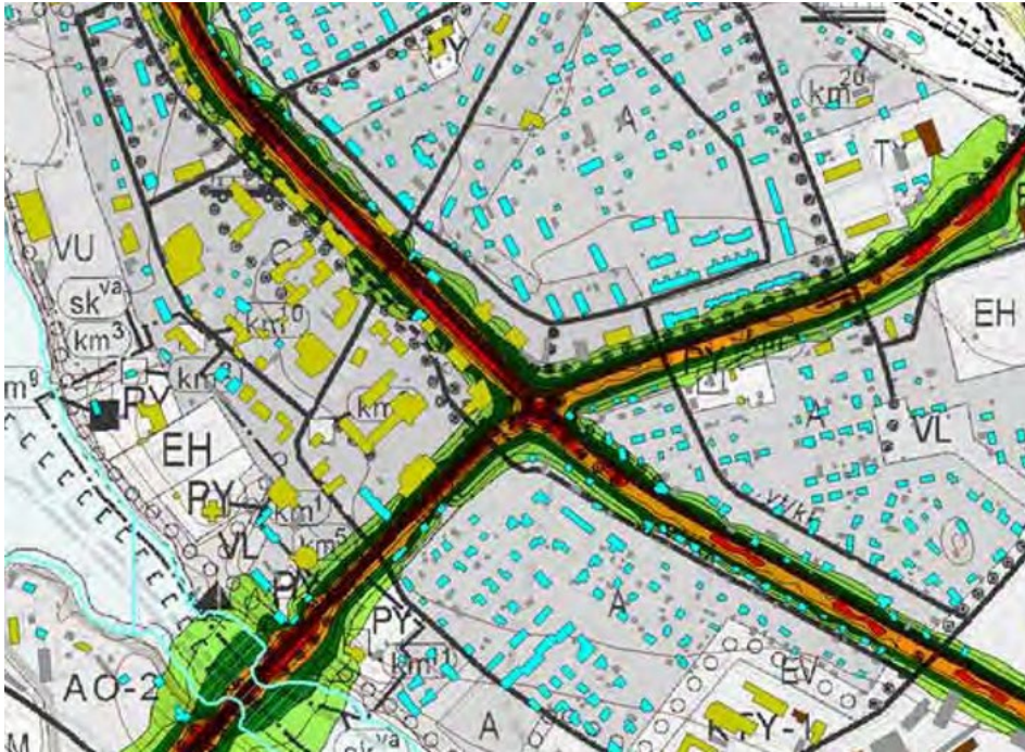
Kuva 6 Tie- ja raideliikenteen yöajan ennuste 2030/40 melukartta (Ramboll Finland Oy 2013). Vaalean vihreä 45-50 dB, tummanvihreä 50-55 dB.
